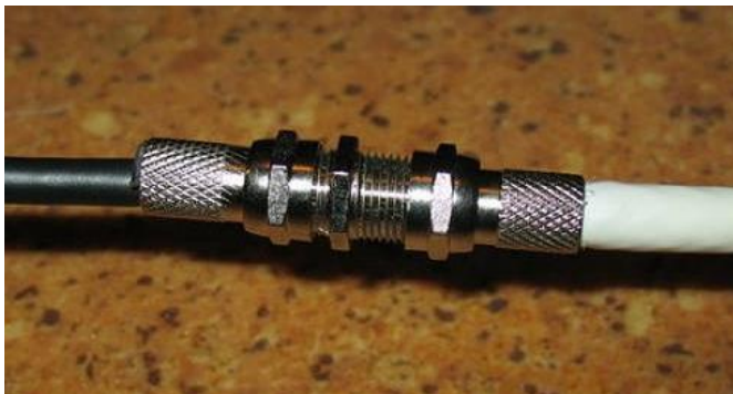
Рис. 3-3. Вариант сращивания коаксиальных кабелей.
