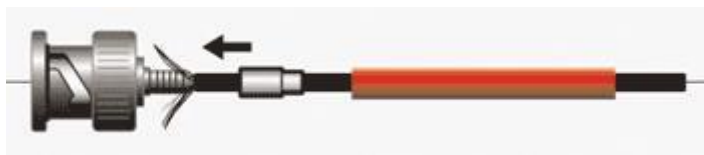
Рис. 7. Разъем перед обжиманием оплетки.
