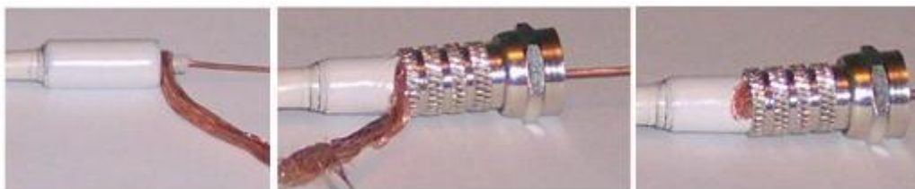
Рис. 5. Зачищенный коаксиальный кабель
