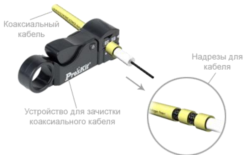
Рис. 4. Надрезание изоляции коаксиального кабеля
