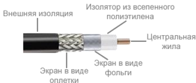
Рис. 2. Коаксиальный кабель с центральным многожильным проводником и экраном-оплеткой
