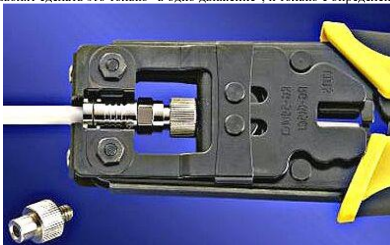
Рис. 8. Обжим оплетки BNC разъема.
